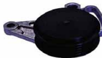
Acero D.E. 60mm D.B. 25.7mm* A - 22.5mm V-Ranurada
