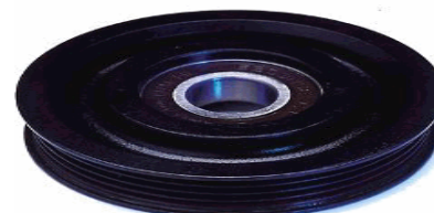
Acero D.E. 80mm D.B. 17mm A - 21.8mm V-Ranurada
