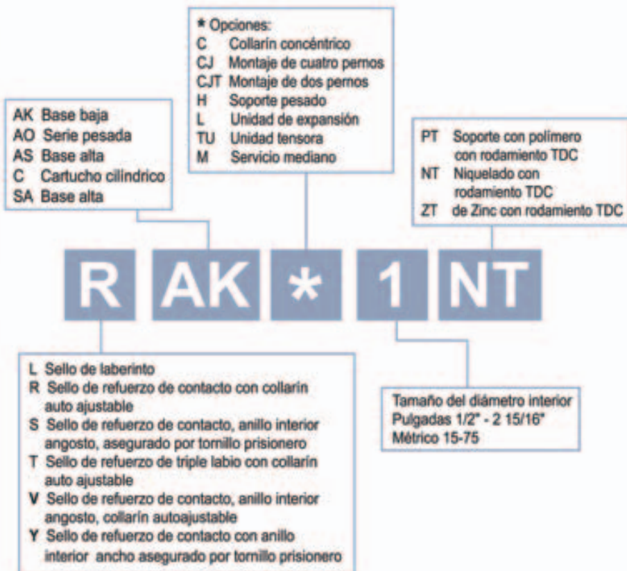
Descripción de la nomenclatura básica de las chumaceras con rodamiento de bolas Fafnir®
