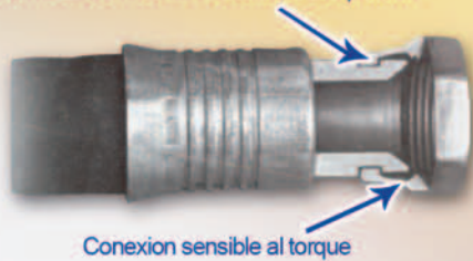
Tuerca deformada con menor resistencia a la presión
