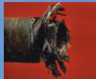
Desprendimiento de conexión por falta de "agarrar" de la conexión contra la manguera.
