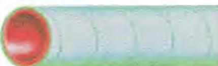
**Línea SIH:** Utilizada en la conducción de anticongelante para el sistema de enfriamiento de camiones y vehículos de servicio pesado. Se fabrica con tubo de silicón, refuerzos multicaspas (2, 3, 4 ó 5) de fibra sintética y cubierta color azul de silicón. Se tienen codos de 90°, 45° y rectas. Excede los requerimientos de la norma SAEJ20R1 Clase A
