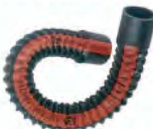
**Durion® Radiador:** Recomendada para usarse en el sistema de enfriamiento como manguera de radiador en todo tipo de camiones y vehículos de servicio pesado o en aplicaciones que requieran resistencia a altas temperaturas. Tubo y cubierta de Silicón, mientras que el refuerzo es de textil sintético. Cumple con la norma SAEJ20R1.
