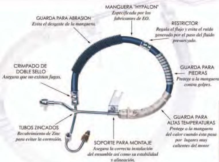
**Ensambles de Dirección Hidráulica Totalmente Equipados**
