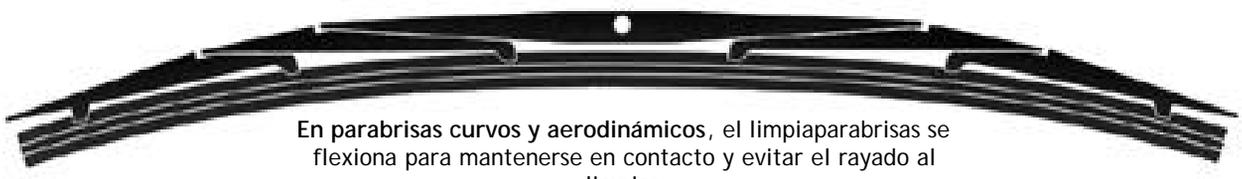
En parabrisas curvos y aerodinámicos, el limpiaparabrisas se flexiona para mantenerse en contacto y evitar el rayado al limpiar.
