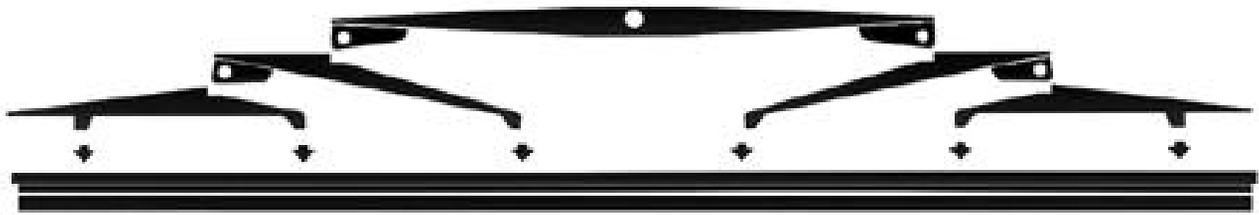
Para alcanzar un **desempeño superior** se requiere de un sistema preciso de distribución uniforme de presión. Las medidas de 16" y en adelante tienen 6 puntos de presión que distribuyen la presión del brazo, a todo lo largo del limpiaparabrisas para conseguir un limpiado parejo.
