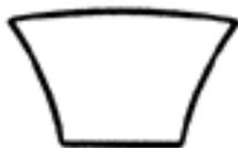
Compensan los efectos que se presentan por el uso normal, como es el "vencimiento de la banda en la polea". Esta curvatura genera un contacto uniforme de la banda con la polea, que significa mejor agarre y transmisión de la potencia eficiente.
