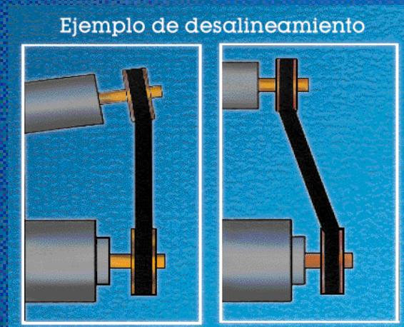
Como has podido constatar, el desalineamiento de la banda siempre se resume a que se disminuirá sensiblemente la vida útil de la misma, además de que pudieran dañarse otros componentes del motor, lo que siempre deriva en reclamaciones y costos extra.
