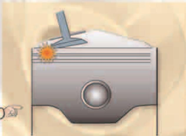
En un motor interfase, una banda que falla causará que los pistones se colisionen contra las válvulas, lo cual resultará en tiempo perdido y daños extremos al motor.
