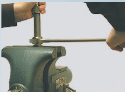
Fig. 4 La llave debe viajar en un plano lineal, en el momento de aplicar la fuerza. La fuerza axial aplicada al tubo lo mantendrá completamente en el fondo de la conexión.
